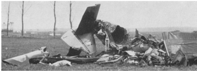
Abb. 1. Absturz eines einmotorigen Prop-Flugzeuges vom Typ Piaggio. Nach der Lage des Flugzeugwracks, der Spuren am Boden in Verbindung mit der Schleuderrichtung der 3 Insassen und der Flugzeugtrümmer stürzte die Maschine im rechten Steiltrudelvorgang ab und schlug fast senkrecht auf dem Boden auf
