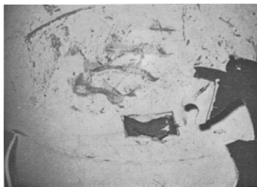
Abb. 9. Fliegerhelm des über See nach Wasserberührung der Maschine tödlich abgestürzten F 104 G-Piloten. Visordeckplatte zertrümmert, am Helmscheitel vier horizontale Anschlagbeschädigungen infolge Kontakt mit einem schmalkantigen Gegenstand (Blendenschutzschild)
